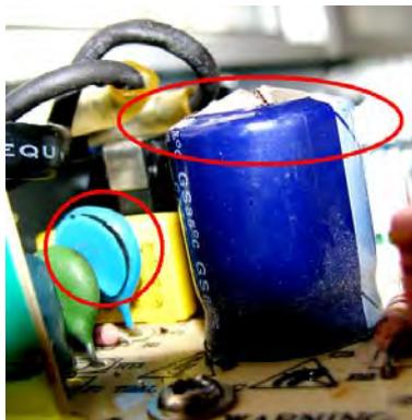
Неисправности радиоэлементов, определяемые визуально – варистор явно пробит высоким напряжением и растрескался. Хорошо видно, что у вздутого конденсатора верх уже не плоский - обычное явление, когда произошло подача высокого напряжения питания сети
