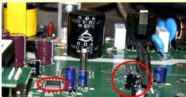
Живые элементы, но только с виду. Высокий ESR конденсатора вызвал последующую неисправность микросборки LNBP. Красным обведено то, что нужно менять в обязательном порядке.
