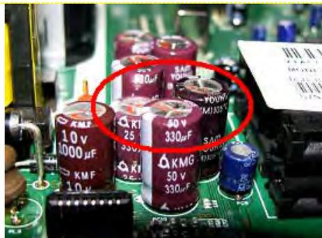
На всех конденсаторах слегка видны сверху следы электролита.
